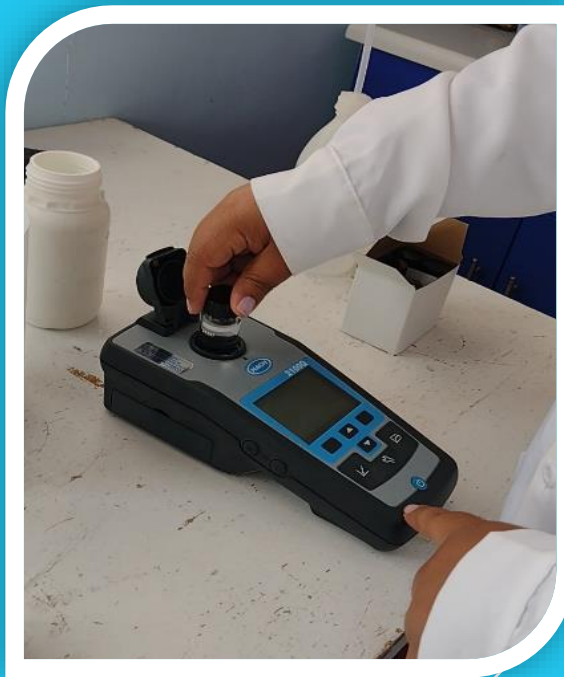
VERIFICACIÓN DE TURBIDÍMETRO HACH21000.
